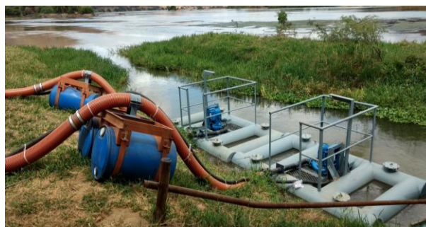
Figura 21 - Balsa de captação de água.
