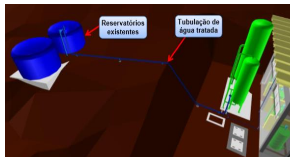
Figura 44 – Previsão de substituição de tubulação dos reservatórios.
